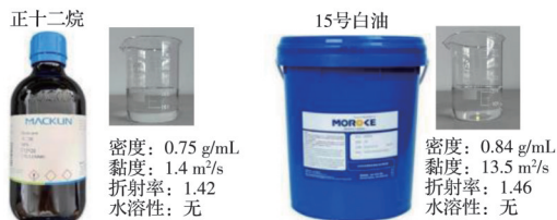
图 3 孔隙液 Fig. 3 Transparent soil pore fluid
